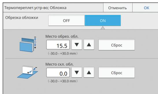
[Место обрез. обл.]: при каждом нажатии [▲] место обрезки сдвигается к основе на 0,1 мм, а размер отрезаемой области увеличивается. При каждом нажатии [▼] место обрезки сдвигается от основы на 0,1 мм, а размер отрезаемой области уменьшается.
