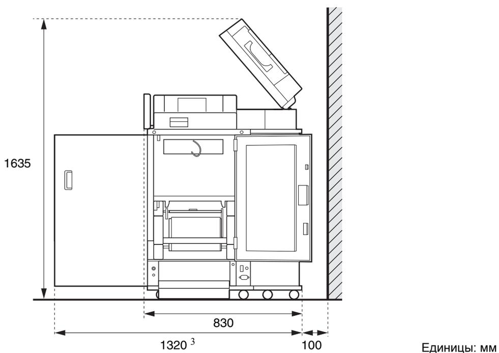
Размеры зависят от используемого дополнительного оборудования.
